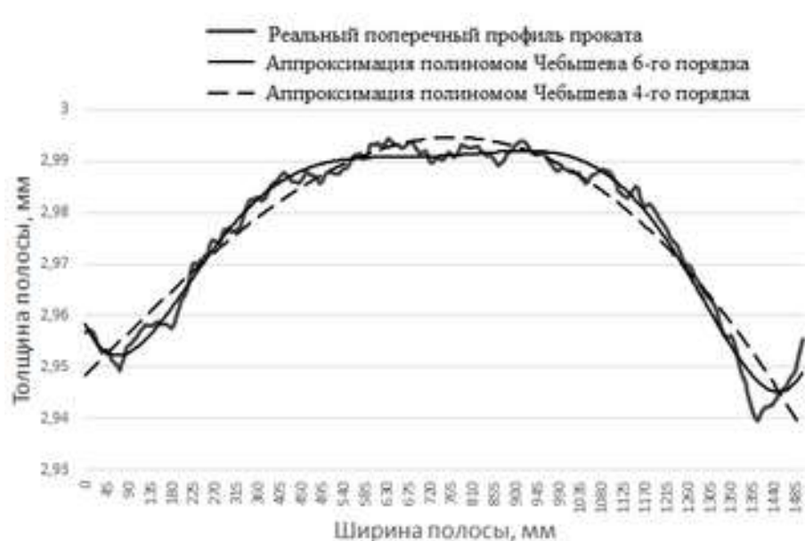
Рисунок 2. Аппроксимация профиля поперечного сечения с прикромочными утолщениями
