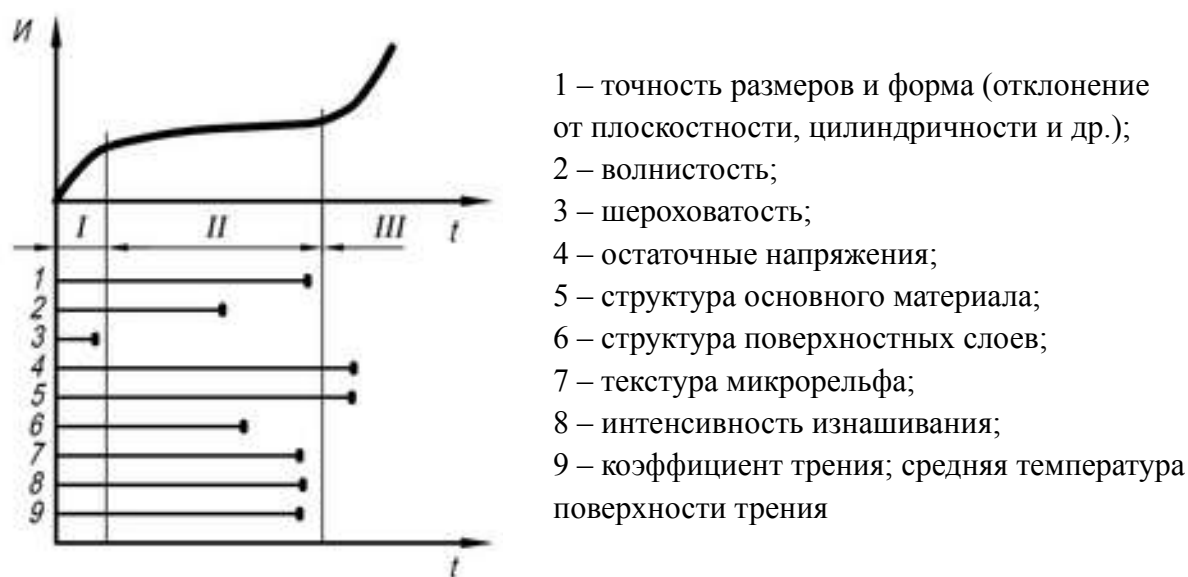
Рисунок 1. Схема изменения начальных показателей качества поверхности и выходных параметров триботехнической системы (ТС) в процессе трения в пределах допустимых отклонений (I – участок приработки; II – участок нормального изнашивания; III – участок форсированного изнашивания)
