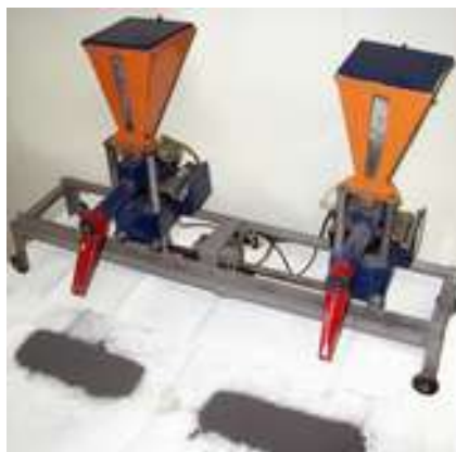
Рисунок 1. Компьютерная (а) и натурная (б) модели разрабатываемой системы механизированной подачи ШОС в кристаллизатор слябовой МНЛЗ при производстве заготовок особо крупного сечения
