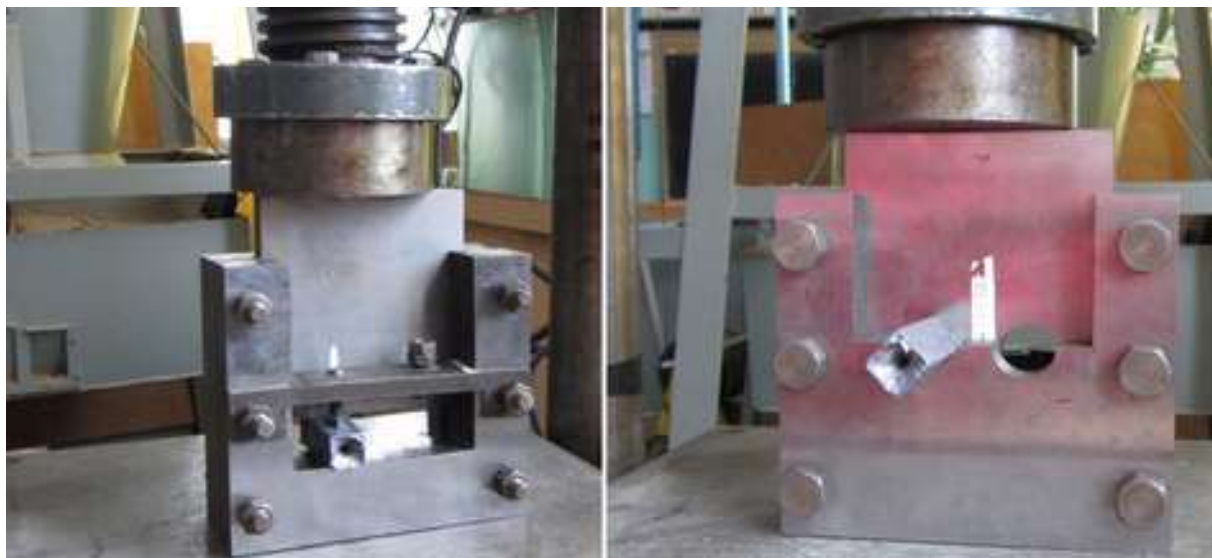
Рисунок 2. Установка для резки заготовок на гидравлическом прессе
