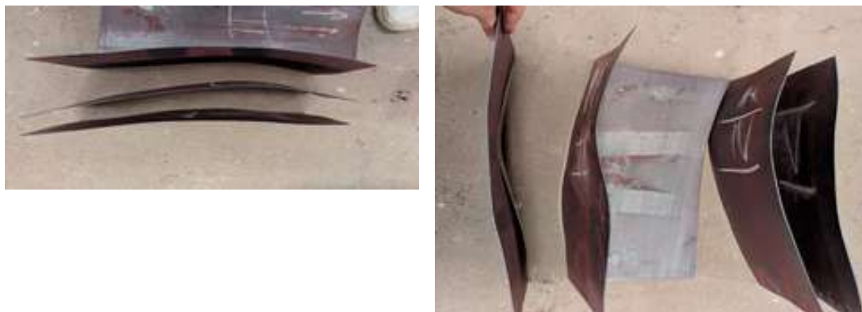
Рисунок 2. Изменение плоскостности h=2 мм.
