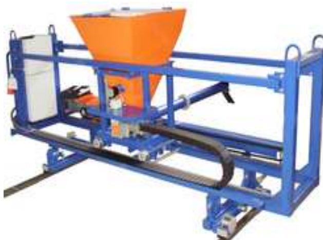
Рисунок 2. Спроектированные отечественные образцы установок механизированной подачи ШОС в кристаллизаторы слябовых МНЛЗ конструкции фирм «Siemens – VAI», «Danieli»(а) и НКМЗ (б)
